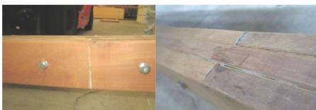
■高い継材・集成材技術の開発により頑丈な長尺材を製造することが出来る
