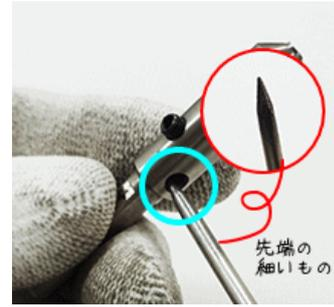
③ 先端の細いものを穴に差し込み、内錐の底を上げるように動かします。
